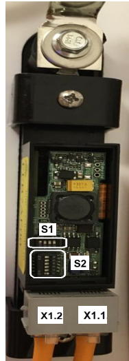
Рисунок 2 – Системная плата замка-считывателя SV HANDLE
